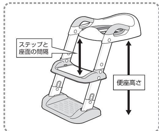
**4** ③の柱(中部)にステップ(上段)と柱(上部)を差し込み、図の★の4箇所(箇所)にネジとナットを通して締め付けます。つないだ柱の3つの穴のうち、どの2つにステップ(上段)を取り付けるかによってステップと座面の間隔を調整できます。
