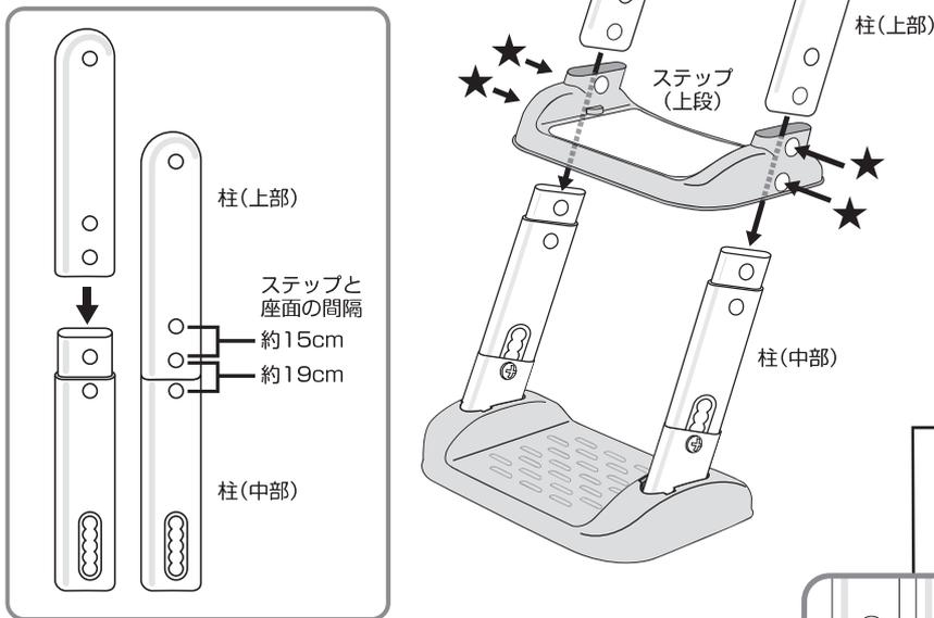
**5** 4の柱(上部)の上に補助便座を乗せ、図の通りにネジとナットを通して締め付けます。
