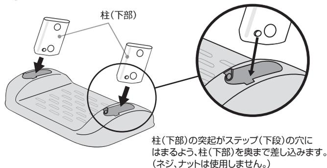
柱(下部)の突起がステップ(下段)の穴にはまるよう、柱(下部)を奥まで差し込みます。(ネジ、ナットは使用しません。)
